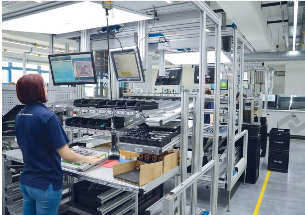
In der Elektronikfertigung bei Ziehl-Abegg ist der intelligente Arbeitstisch „Schlauer Klaus“ an sechs Arbeitsplätzen integriert.
