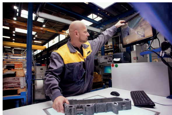
Ersatzteile für über 600 Motorenvarianten werden optisch identifiziert
